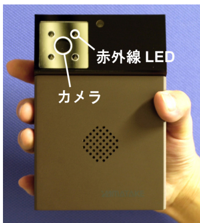
(c) 虹彩認証装置の試作機
