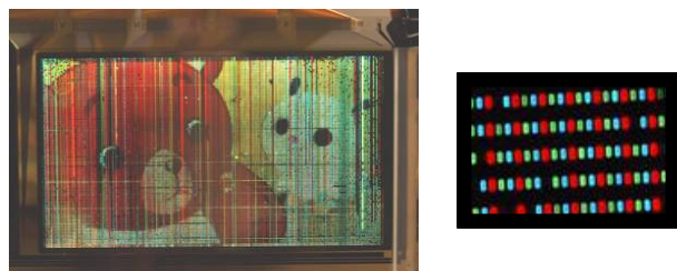
第 7 図 試作ディスプレイのカラー動画表示(左)と拡大写真(右)
