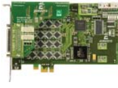
写真 3 “Picolo Alert Compact Pcle”画像取り込みボード(PCI Express 1 スロット仕様)
