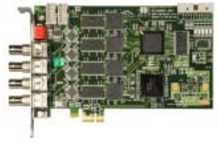
写真 4 “Picolo Diligent Plus”画像取り込みボード(PCI Express 1 スロット仕様)
