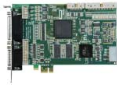
写真 5 “Domino Symphony Pcle”画像取り込みボード(PCI Express 1 スロット仕様)
