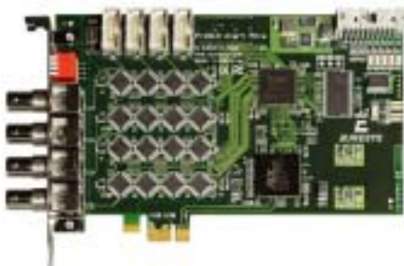
写真 2 “Picolo Alert Pcle”画像取り込みボード(PCI Express 1 スロット仕様)
