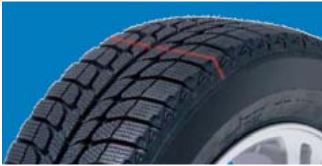
第 12 図 タイヤゴムの溝形状および深さ方向検査
