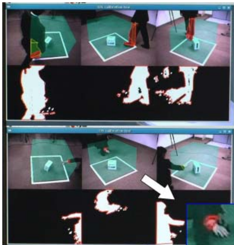
第 14 図 検知結果（上段：足を踏み入れた状態，下段：手を伸ばした状態）
