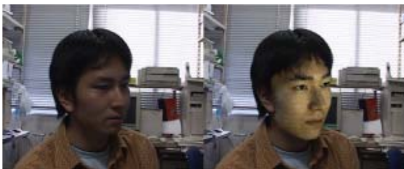
第6図 姿勢推定例（左：入力 30[deg]，右：推定後の3次元データ 30[deg]の重ね合わせ）
