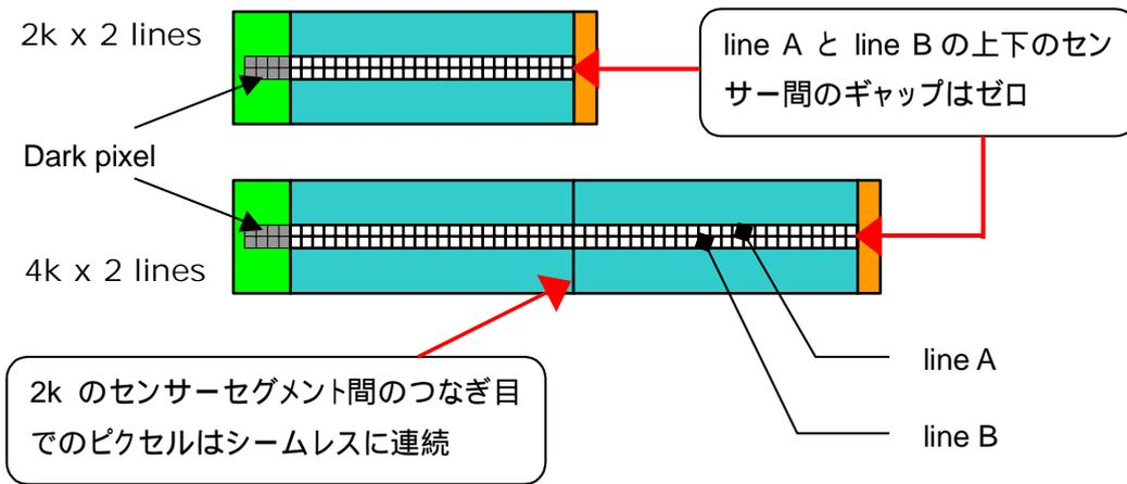
第4図 sprint CMOS デュアルセンサーの構造
