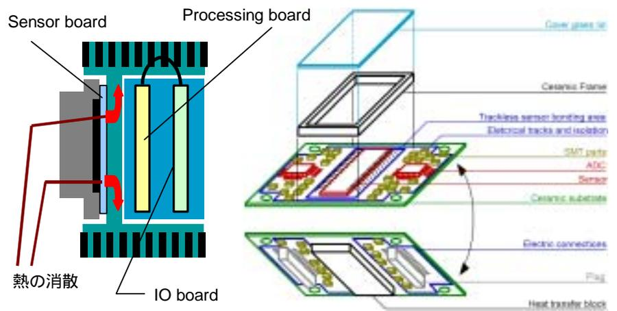
第7図 sprint ハウジングと CMOS デュアルセンサーモジュールの構造と放熱のしくみ
