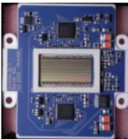
第5図 sprint CMOS デュアルセンサーモジュールの外観
