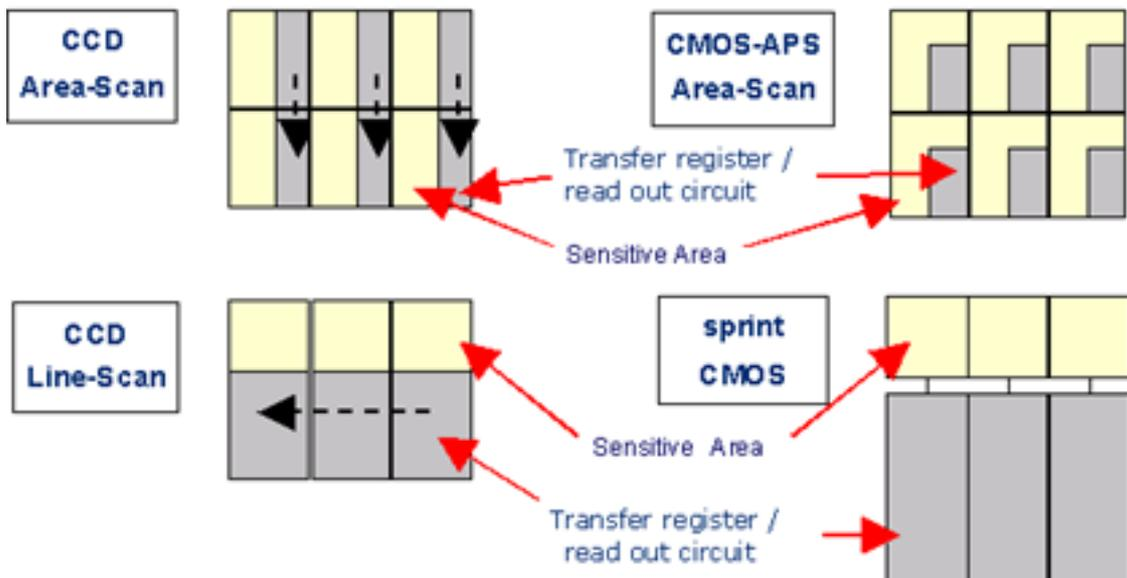
第 3 図 sprint CMOS デュアルラインセンサーの受光面
