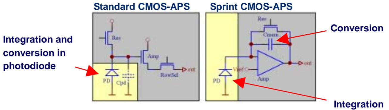
第 2 図 sprint CMOS のユニークな構造
