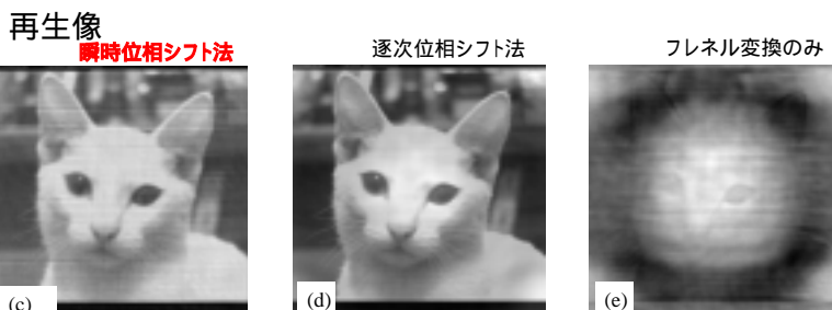
第6図 各種デジタルホログラフィの計算機シミュレーション結果 (a)被写体の振幅分布、(b)被写体の位相分布、(c)瞬時位相シフトデジタルホログラフィによる再生像、(d) 逐次位相シフトデジタルホログラフィによる再生像、(e)フレネル変換のみによる再生像
