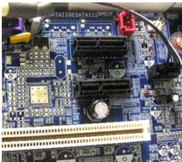
第 3 図 現在主流となっている PCI Express x1 スロット
