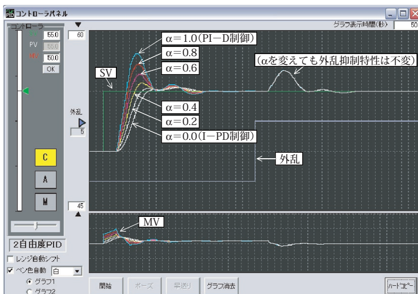
図 1 P のみ 2 自由度 PID 制御の \alpha を可変した時の応答特性
