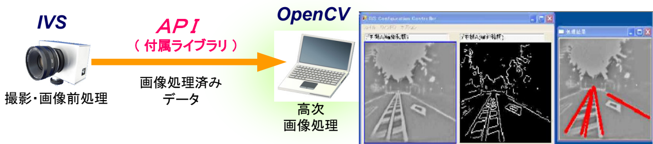
第5図 IVS と OpenCV を組み合わせた画像処理環境
