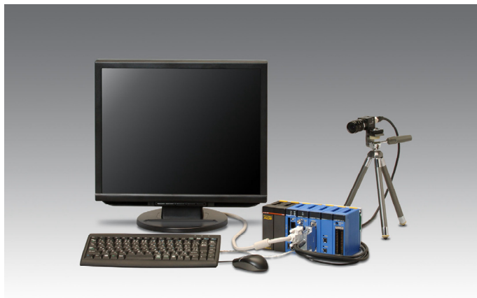
写真2 e-RT3 2.0 マシンビジョン構成
