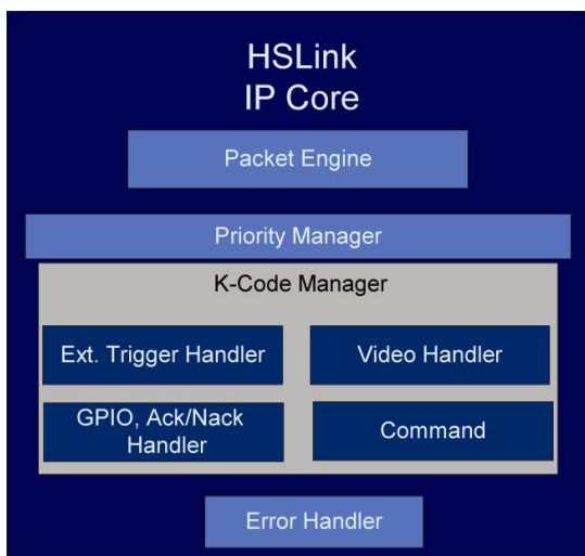
第 2 図 HSLink IP core は全てのリアルタイム信号、コマンドメッセージおよびデータ信頼性を高めるデータ再送を制御する。
