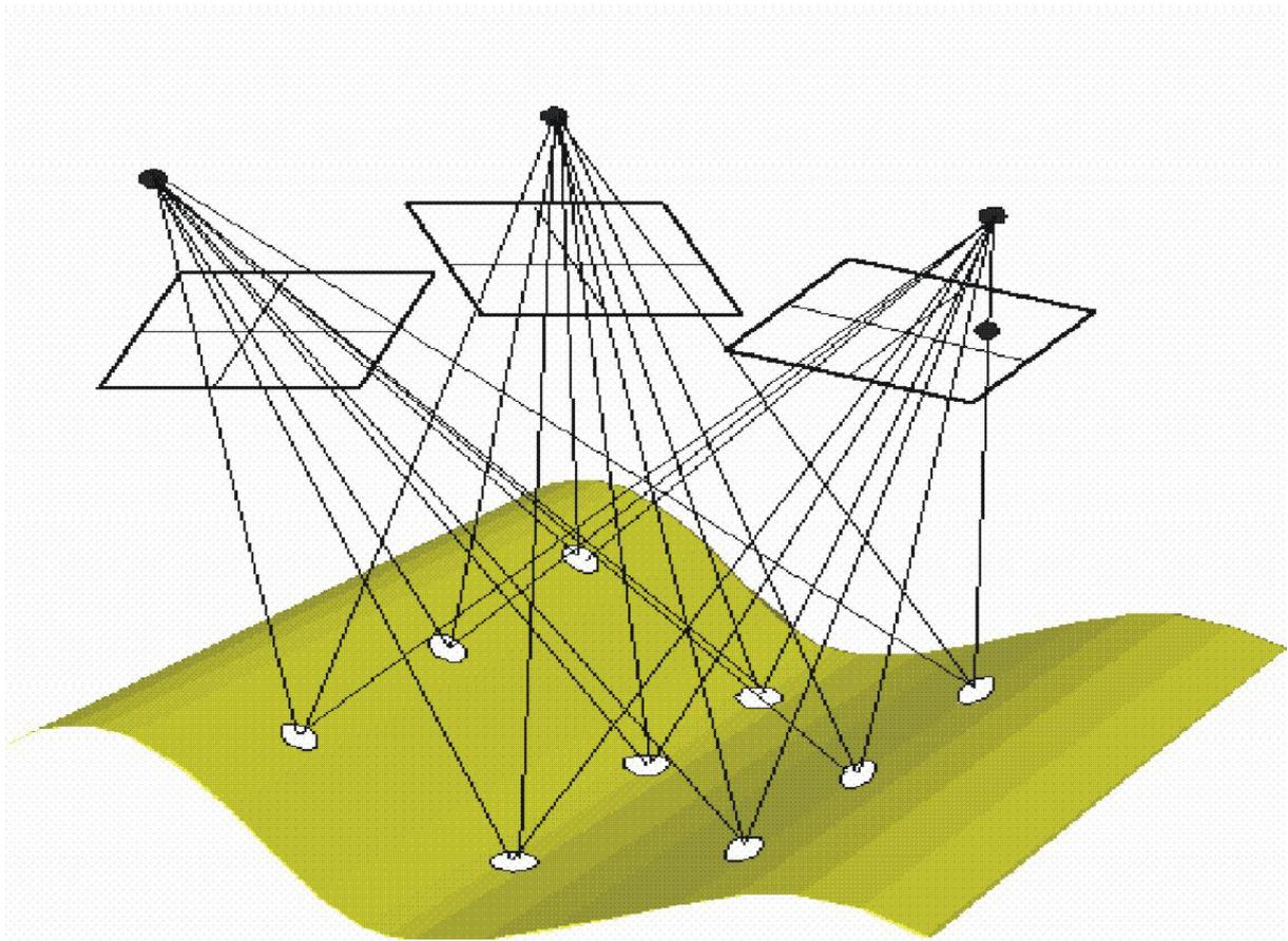
第1図 写真計測の概念
