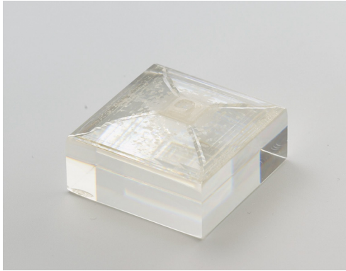
写真1 KTN結晶の概観 (50x50mm 2 )
