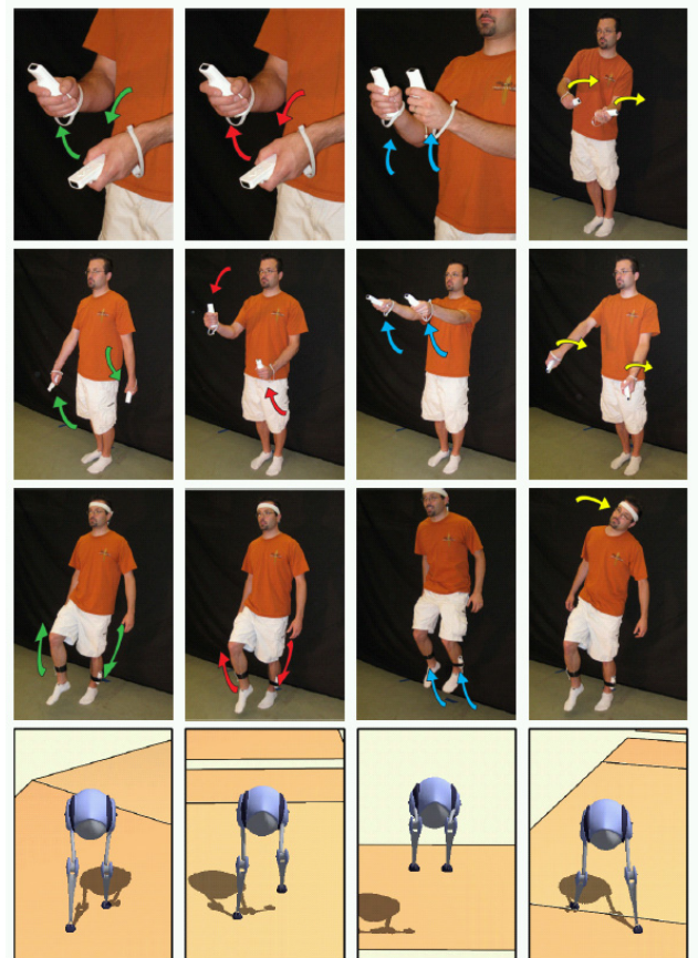
第 6 図 インターフェイスのコマンドとそれに付随するキャラクタの動き。上から Wrist Interface, Arm interface, Leg interface, キャラクタの動きを示し、左から歩行、走行、ジャンプ、旋回のコマンドを示す。
