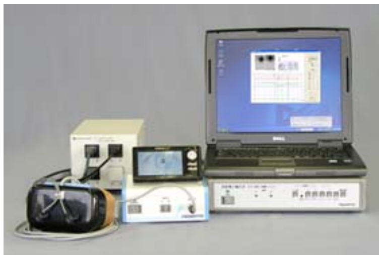
第 6 図 両眼電子瞳孔計 外観図
