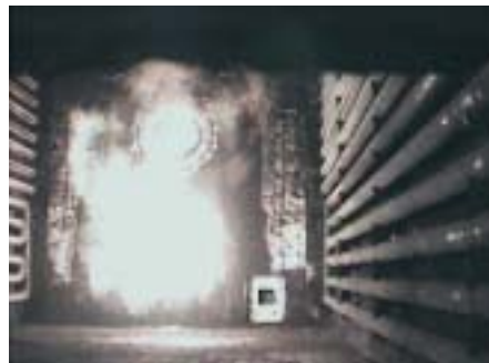
写真5 加熱炉内温度計測(可視画像)
