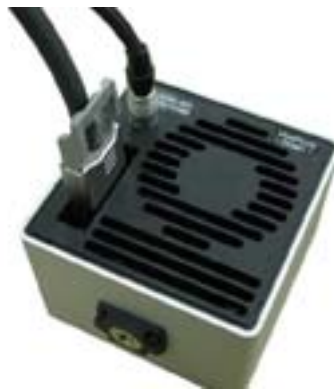
第 6 図 ProFUSION 25 へケーブルを接続した様子
