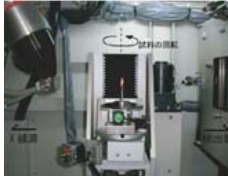
第 2 図 \mu CTによるデータの収集。 X線源と検出器の間にあるステージ上に試料を置き回転させる。
