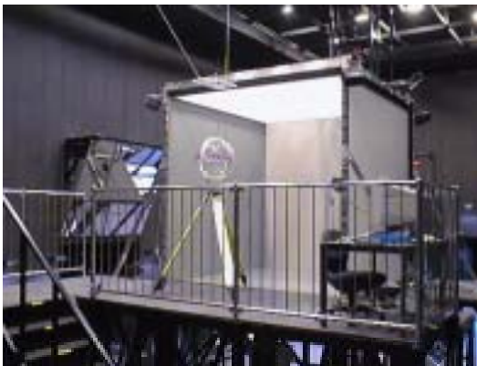
第 2 図 没入型仮想空間生成装置
