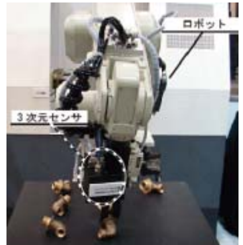
第 5 図 ロボットアームによるピン ピッキング (文献[27]より引用)
