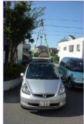
写真2 Ladybug カメラヘッド及び車載例
