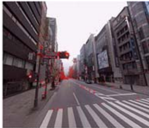
カメラベクトルを求めるために 自動抽出された特徴点群
