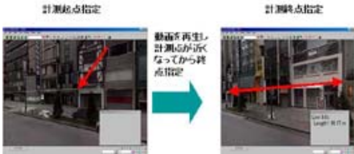
写真9 フレーム間距離計測
