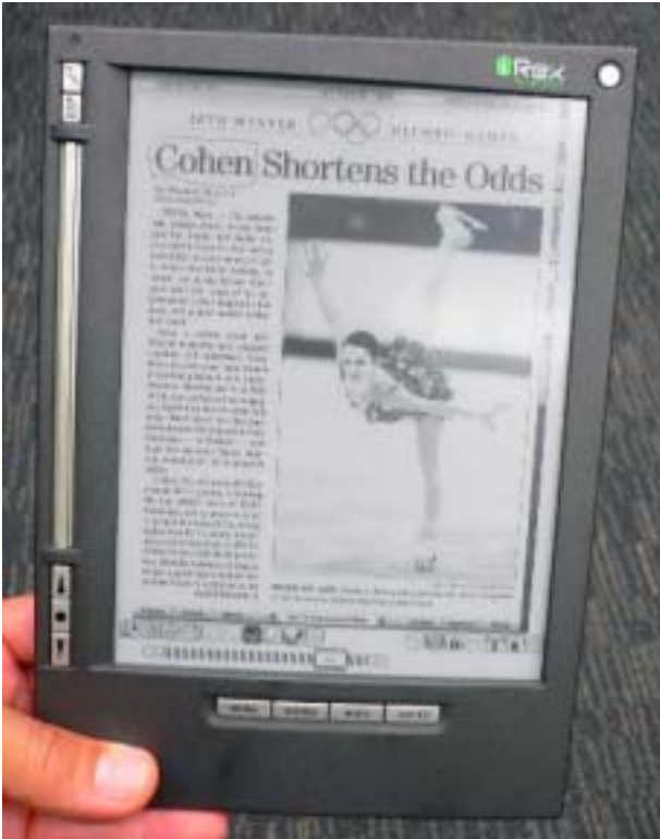
第2図 電気泳動方式を用いた電子ペーパー装置 市販品 (iRex Technologies 社)
