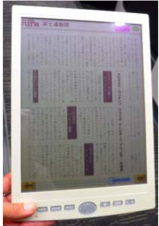
第3図 コレステリック液晶による A4 カラー表示媒体
