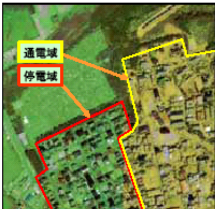
写真9 高分解画像で見る停電域
