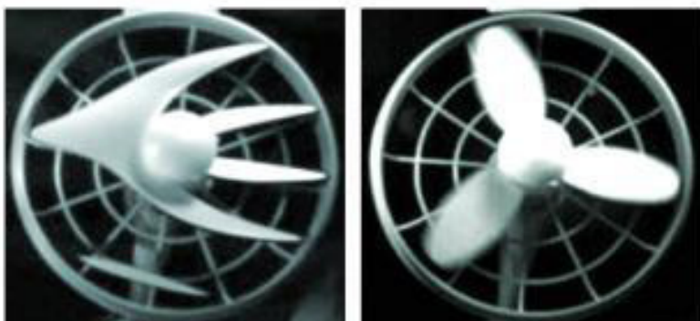
(a) ローリングシャッター (b) グローバルシャッター 写真1 高速で回るファンの撮像した画像
