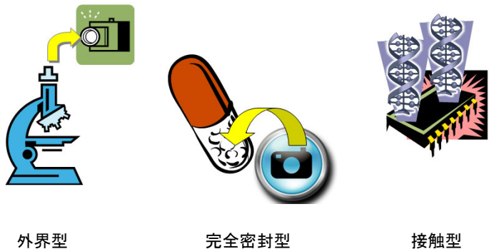
第3図 バイオ医療用 CMOS イメージセンサの方式
