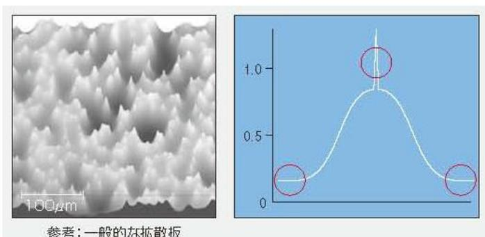
第5図 一般的な拡散板
