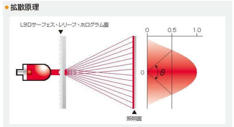
第3図 拡散原理
