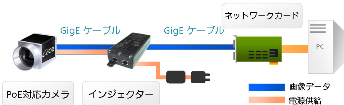
第3図 PoE カメラ接続: インジェクターから電源供給
