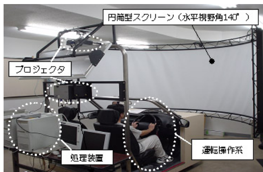
第 2 図 運転視力測定システムの構成
