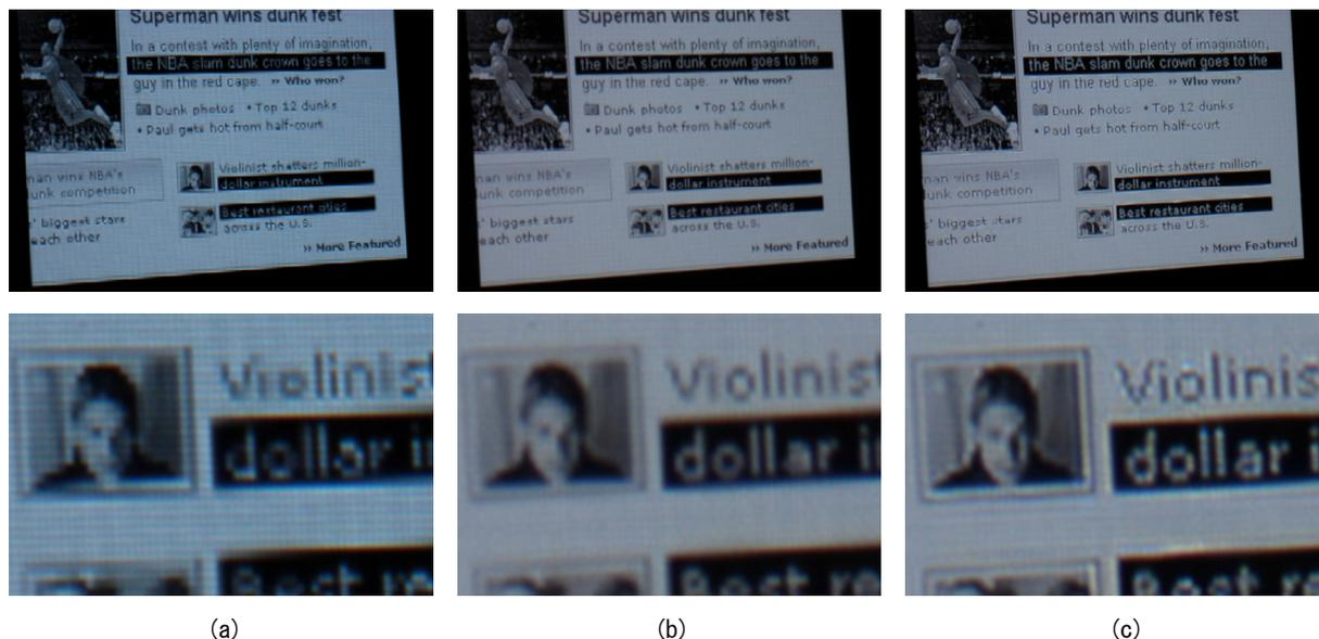
第3図 実験結果。(a)は1台、(b)は8台の投影像をただ重ねたもの、(c)は最適化計算によって得られた画像
