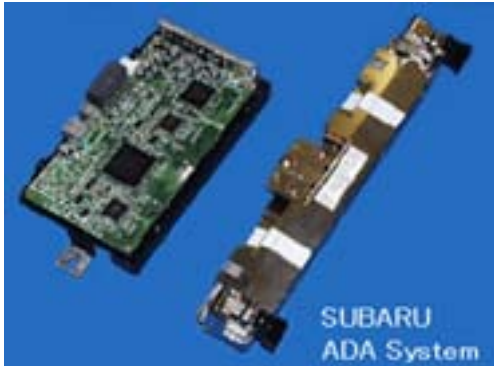
第 1 図 自動車用のステレオカメラ(右)と画像処理ユニット
