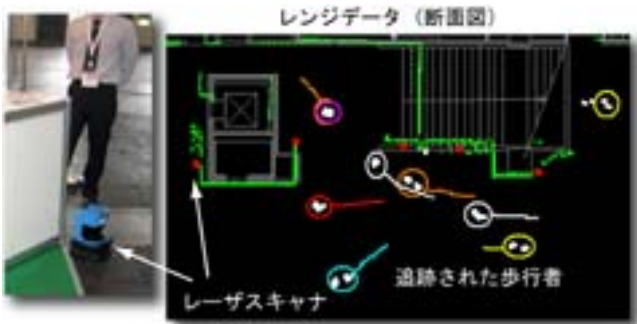
第 1 図 マルチレーザスキャナを用いた歩行者追跡
